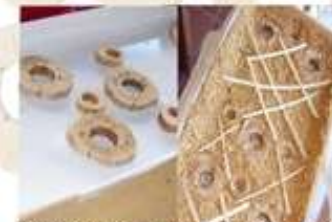
Armado de la placa, prensado, secado y corte. Incrustación de fibras de refuerzo.
