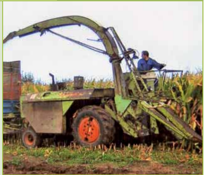
La JAGUAR 60 SF de 1975 consigue aprox. 0,5 ha por hora en maíz forrajero.
